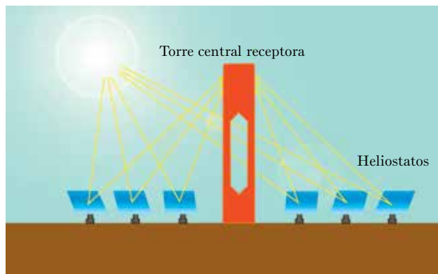
Figura 11 Diagrama esquemático de una planta reguladora de torre de energía
