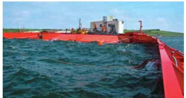
Figura 48 Diagrama esquemático de un dispositivo de desbordamiento y su prototipo en el mar
