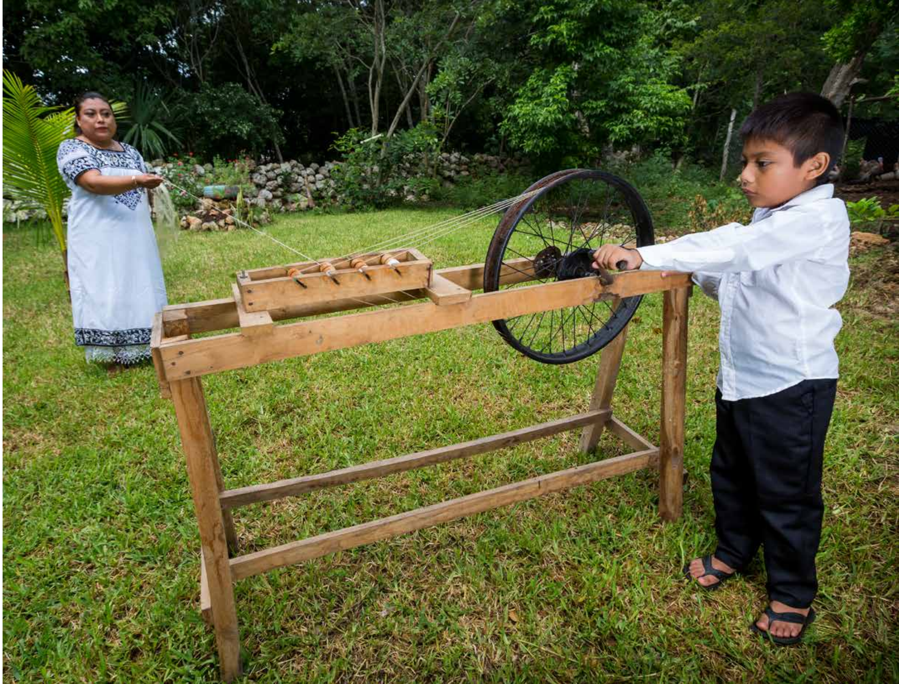
De la página 154 a la 158 se puede apreciar el proceso de corchado de henequén o de chelem para conformar el cordel con el que se tejerán este tipo de hamacas.
