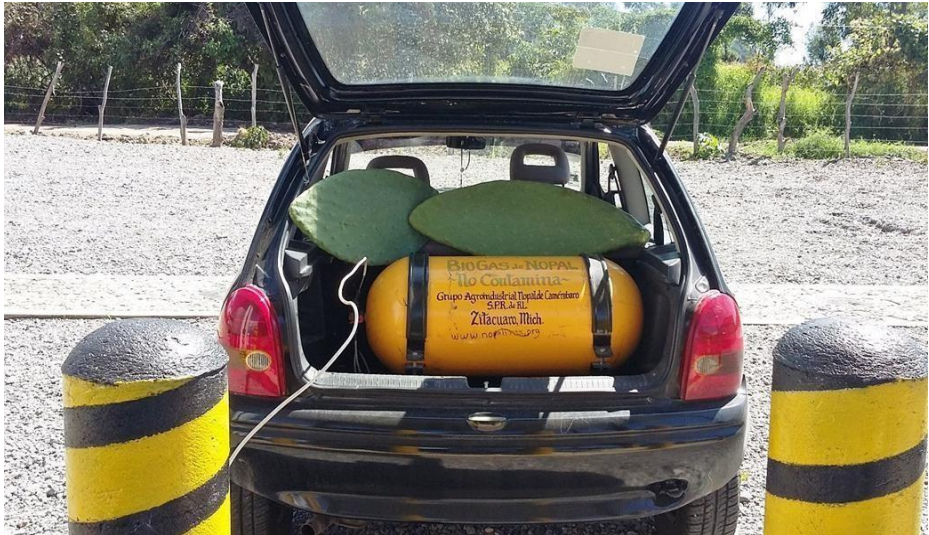
Tanque de biogás colocado en la cajuela del vehículo Fuente: Nopalimex
