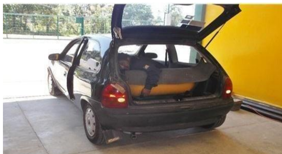
14 de marzo de 2016, adaptaciones al Vehículo de la planta para colocar el tanque de biogás Fotos: Nopalimex
