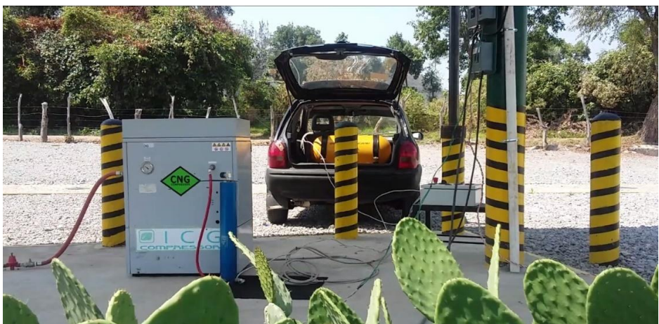
Compresor de biogás alimentando biogás de nopal al vehículo Fuente: Nopalimex
