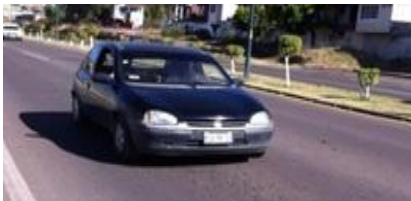
El día 14 de marzo de 2016 se realizó la primera prueba de recorrido con un vehículo de la planta con biogás a base de nopal, concluyendo las pruebas sin problema alguno Fotos: Nopalimex
